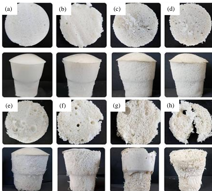
Figura 19 - Aspecto visual dos sistemas imobilizados in situ com (a) 1, (b) 3, (c) 5, (d) 6, (e) 7, (f) 8, (g) 9 e (h) 10 g de biomassa (210 g L -1 ).
