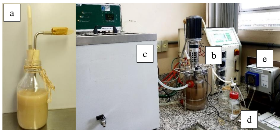
Figura 10 - (a) Sistema para preparo do inóculo; e sistema para produção de biomassa: (b) reator encamisado, (c) banho ultratermostato, (d) Controlador de pH, (e) bomba peristáltica.
