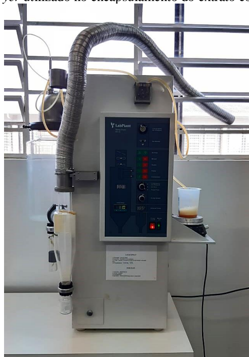
Figura 12- Aspecto geral do spray dryer utilizado no encapsulamento do extrato concentrado carotenoides.
