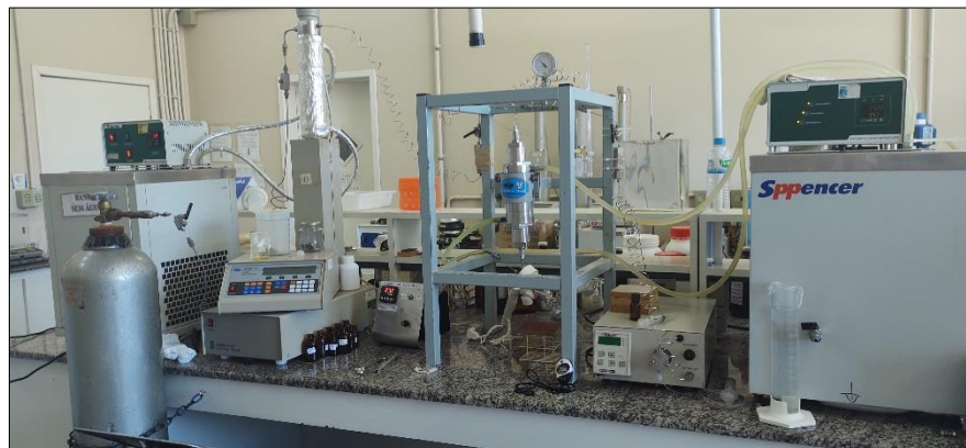
Figura 8- Unidade de extração subcrítica.
