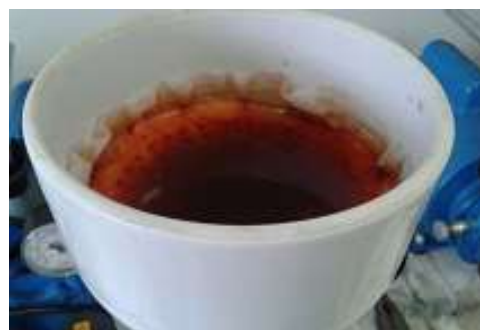
Figura 5 – Calda residual tratada somente com PAC durante processo de filtração à vácuo.
