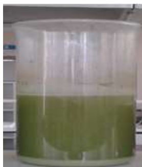
Figura 4 – Calda residual após tratamento primário com PAC + gel-floc.
