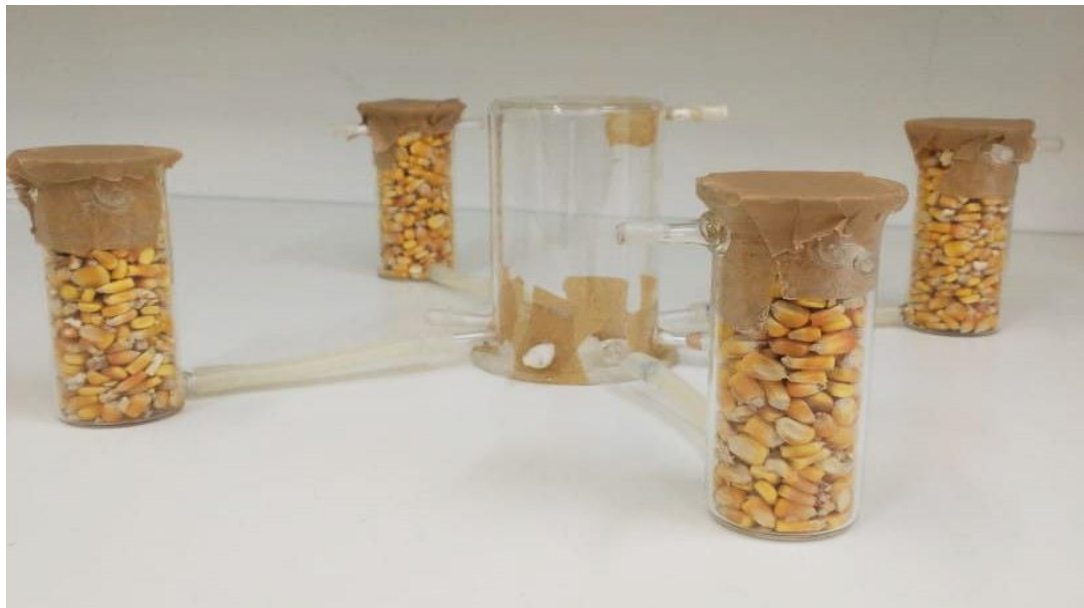
Figura 10 - Mini-silos utilizados no teste de repelência com o óleo essencial de Cinnamomum cassia , na forma livre (a) e encapsulada (b).
