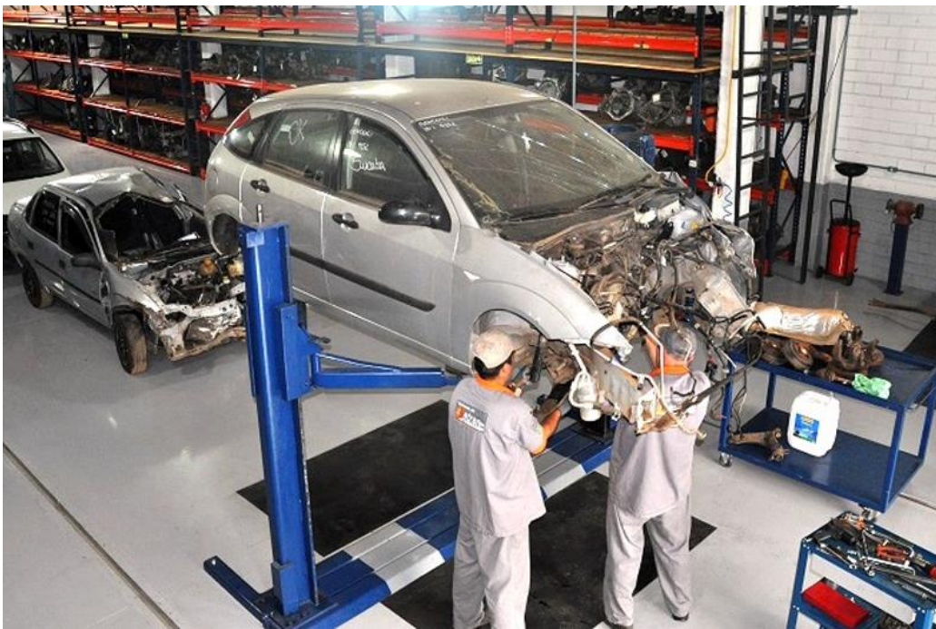
Figura 4: Linha de desmontagem de um CDV
