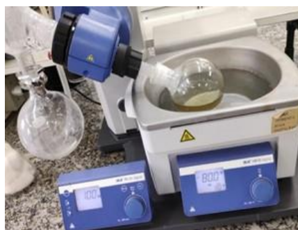
Figura 1: Sistema de reação para síntese do líquido iônico [TEA][HSO 4 ]
