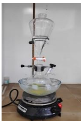
Figura 1: Sistema de reação para síntese do líquido iônico [TEA][HSO 4 ]
