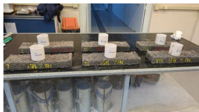
Figura 6 - Ensaio de taxa de infiltração a) montagem dos prismas com o tubo, (b) colocação dos primas em tanque e (c) colocação da água com a medição do tempo de infiltração
