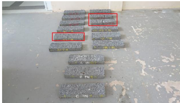
Figura 7 - Placas com trintas após exposição no tempo
