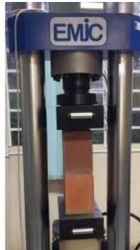
Figura 5 – Posicionamento do prisma na prensa
