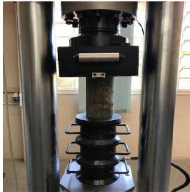
Figura 01 – Ensaio de compressão uniaxial
