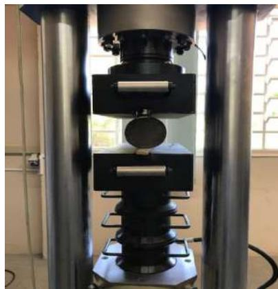
Figura 2 – Ensaio de compressão diametral
