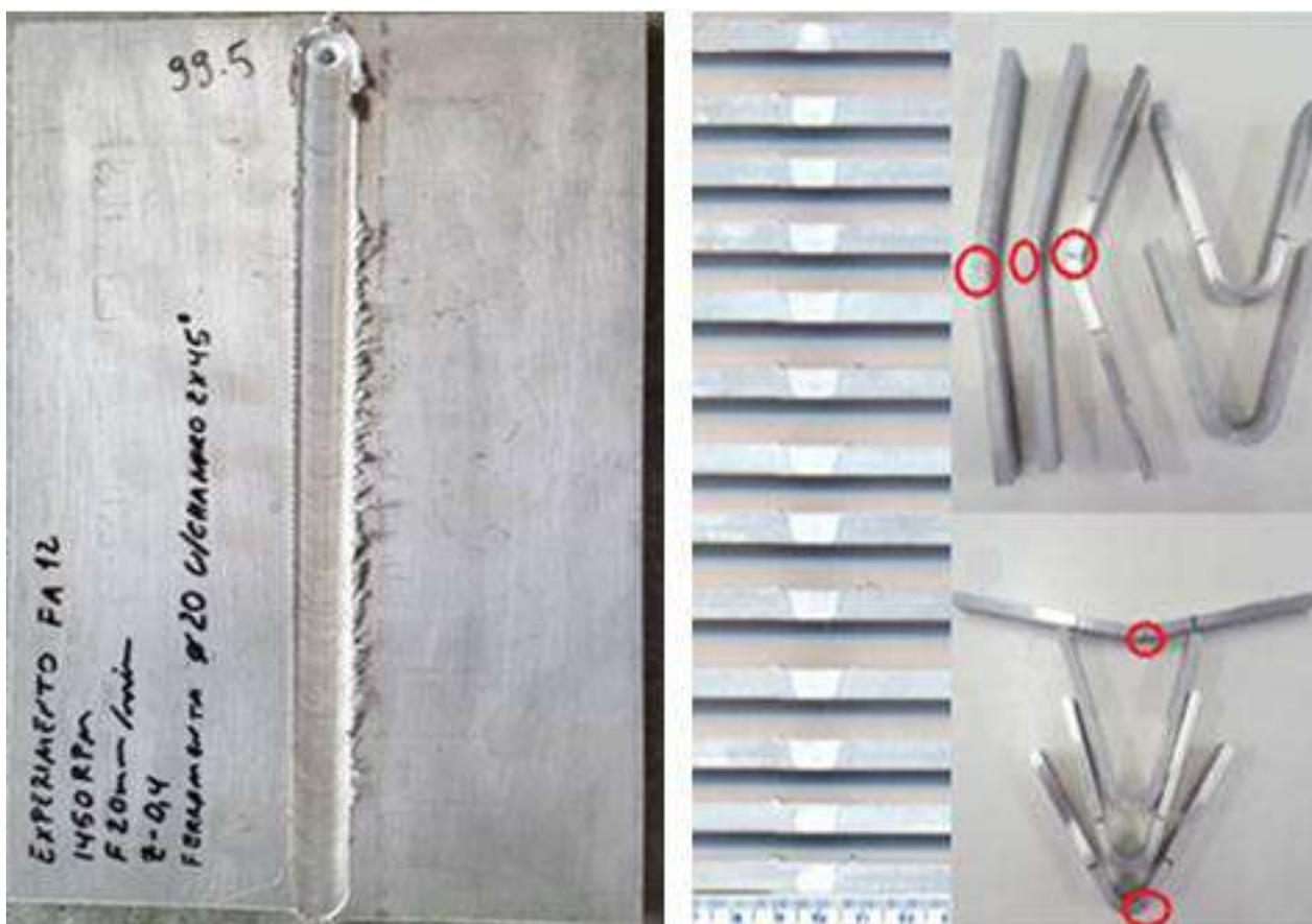
Figura 2 – Chapa soldada, macrografia e amostras após dobramento
