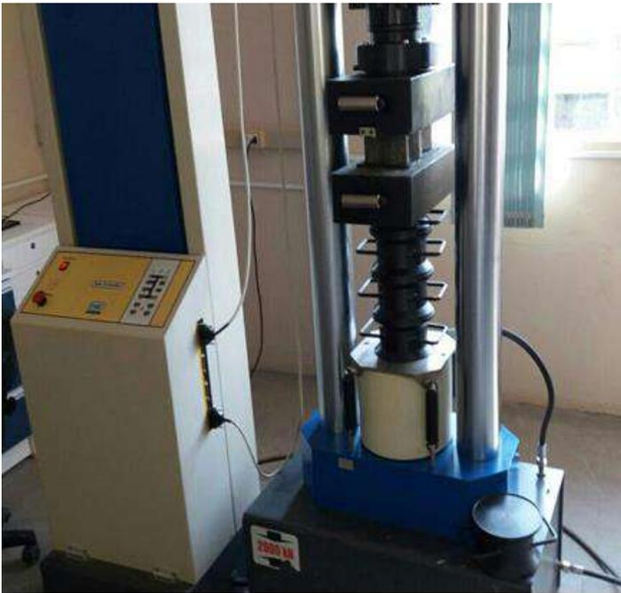
Figura 5 – Ensaio de compressão.
