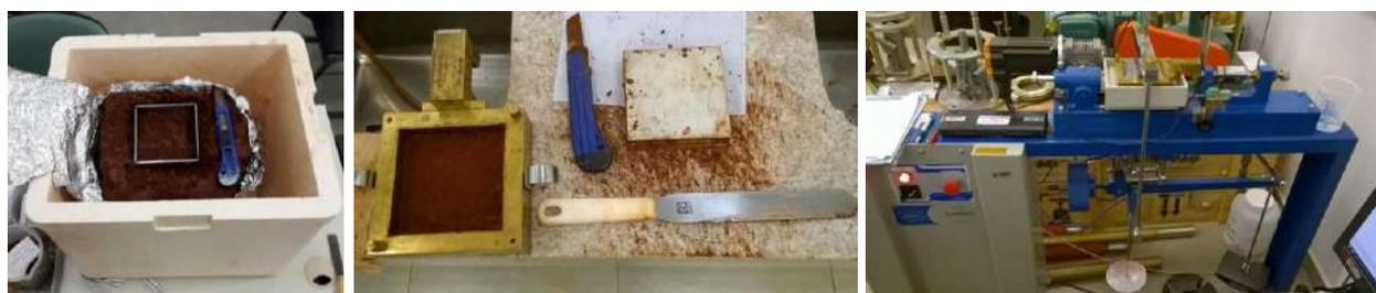
**Figura 2** – Preparação das amostras e execução do ensaio de cisalhamento direto.
