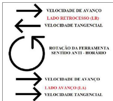
Figura 1 - Desenho esquemático sobre o comportamento do material durante a soldagem FSW.
