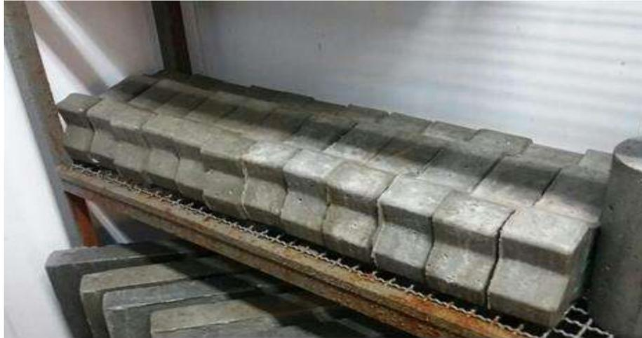
Figura 4 – Corpos de prova desmoldados e dispostos em câmara úmida.
