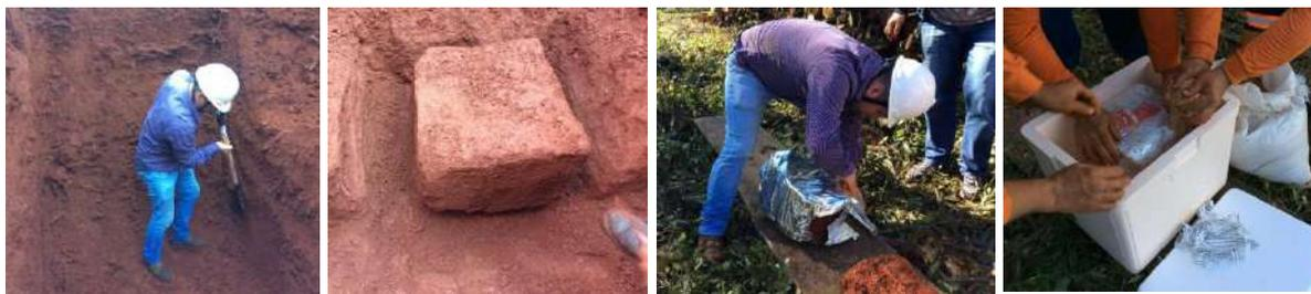
**Figura 1** – Procedimentos de coleta das amostras de solo.
