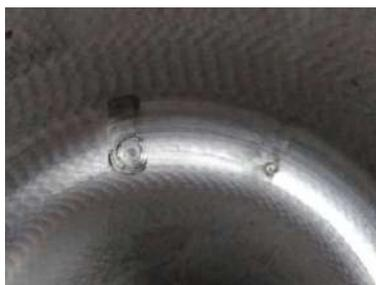
Figura 7 - Defeito na chapa, ocasionado por impurezas
