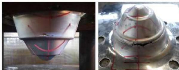
Figura 5 - Rompimento da chapa no terceiro estágio – 75°
