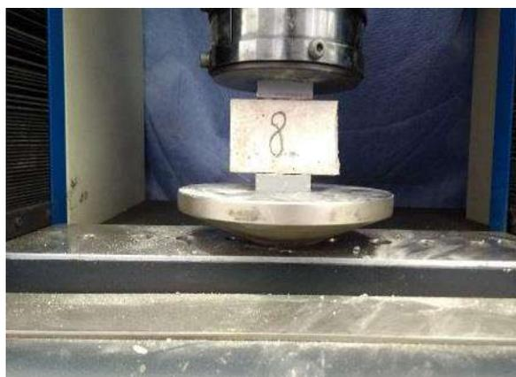
Figura 3 – Metade dos corpos de prova posicionados na prensa para ensaio de resistência à compressão axial.
