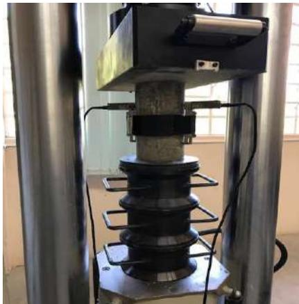
Figura 5 – Ensaio de módulo de elasticidade longitudinal
