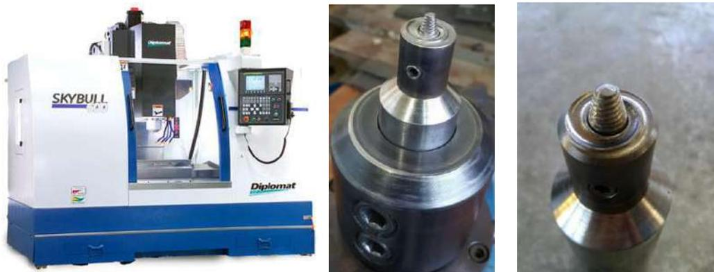
Figura 1 – (a) centro de usinagem (b) ferramenta dos dois primeiros experimentos (c) ferramenta dos dois últimos experimentos.
