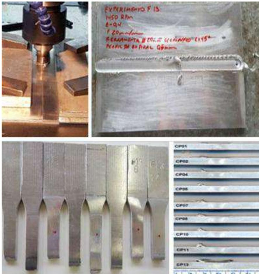
Figura 3 – Processo de solda, Chapas soldada, amostras após tração e macrografia
