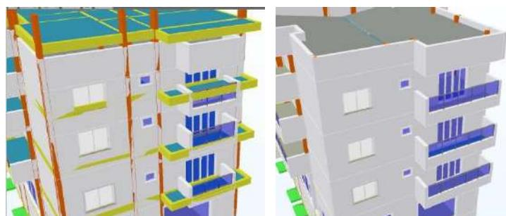
Figura 2 - Incompatibilidade e correção das sacadas entre o projeto estrutural e o arquitetônico.
