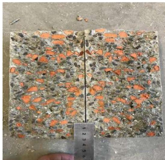
Figura 7 – Ensaio de absorção de água por capilaridade
