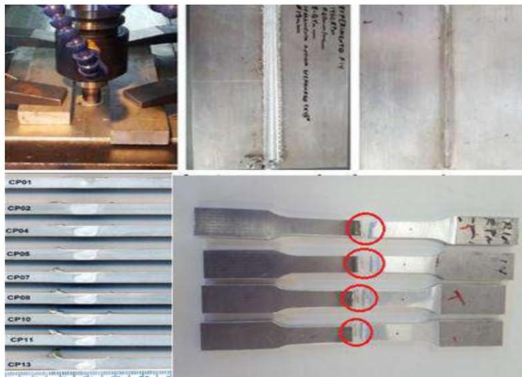
Figura 4 – Processo de solda, Chapas soldadas superior e inferior, macrografia amostras após tração
