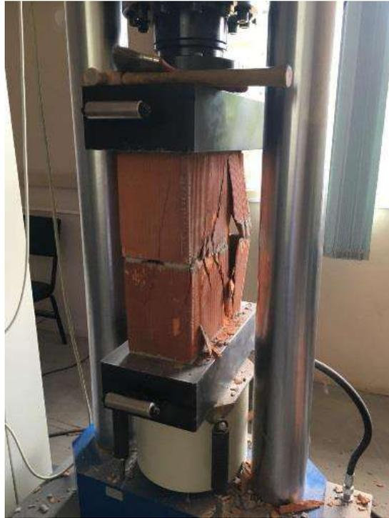
Figura 4 – Prisma de dois blocos rompido na prensa hidráulica.
