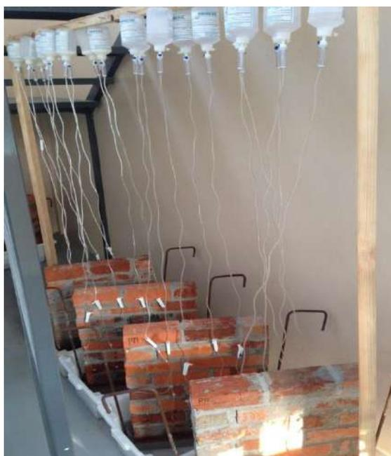
Figura 2 – Aplicação dos produtos impermeabilizantes
