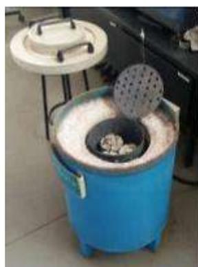
Figura 3 – Aquecimento dos corpos de prova no forno mufla
