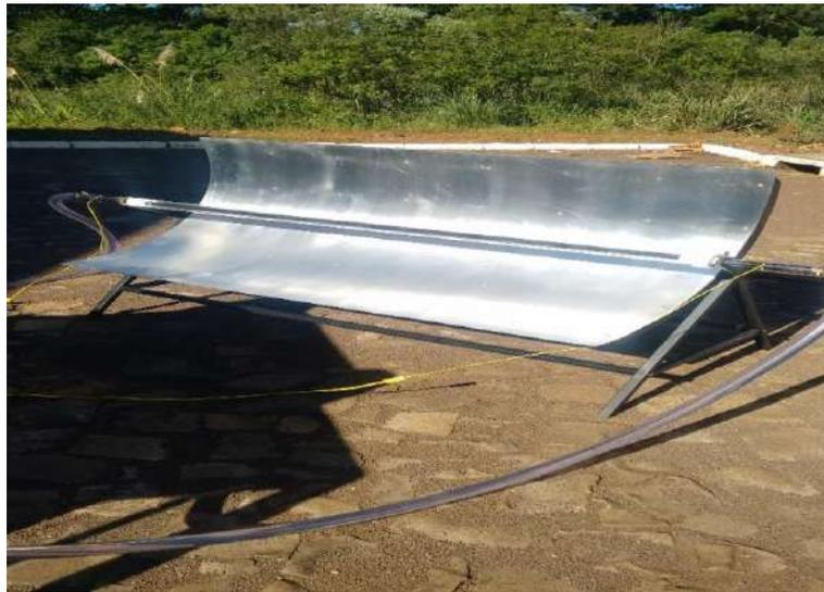
Figura 1 – Concentrador solar em experimento.
