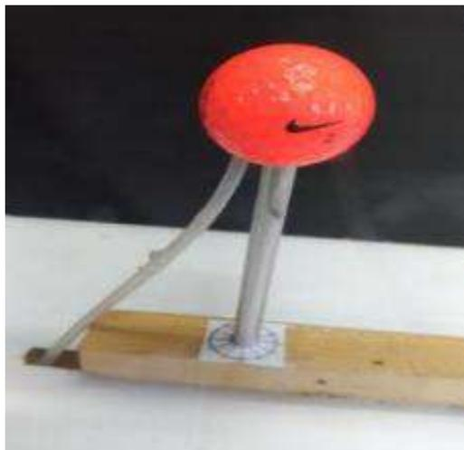
Figura 3 – Suporte para medição de pressão fixado na bola.
