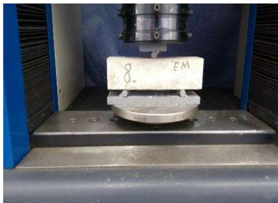
Figura 2 – Corpos de prova posicionados na prensa para ensaio de resistência à tração na flexão.
