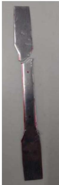
Figura 2 - Ruptura do corpo de prova
