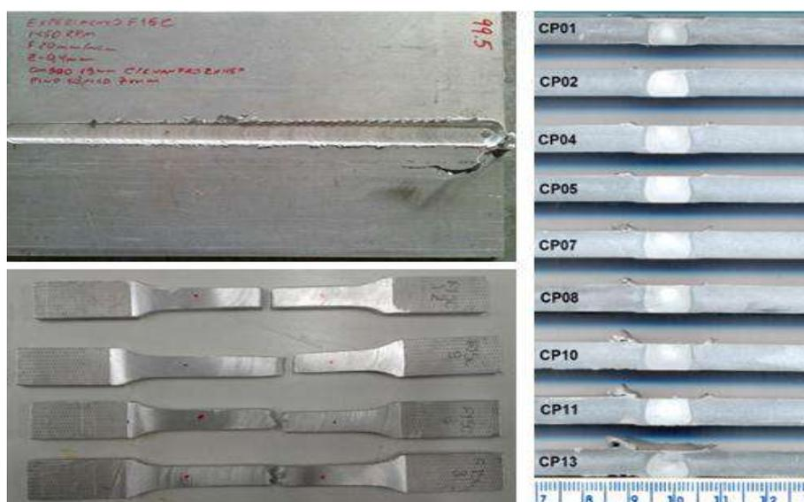
Figura 5 – Chapa soldada, macrografia e amostras após tração
