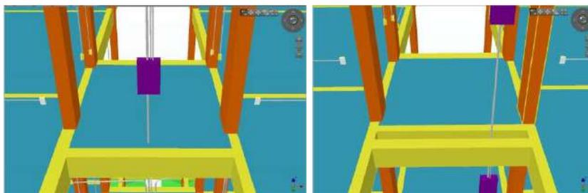
Figura 8 - Incompatibilidades e correção na passagem das tubulações elétricas nos shafts.
