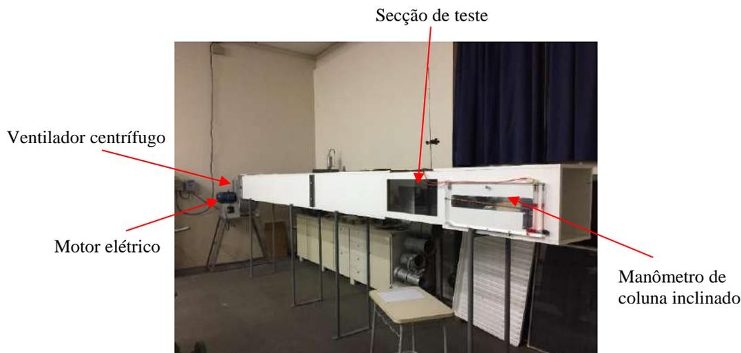
Figura 2 – Canal aerodinâmico.
